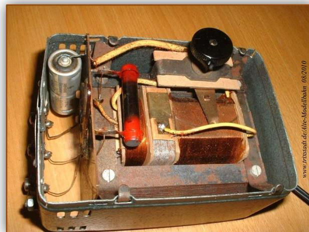
Couvercle démonté, on voit nettement de gauche à droite : le gros condensateur (blanc), une résistance abaisseuse de tension (rouge) et le bouton (noir) du curseur de vitesse.
