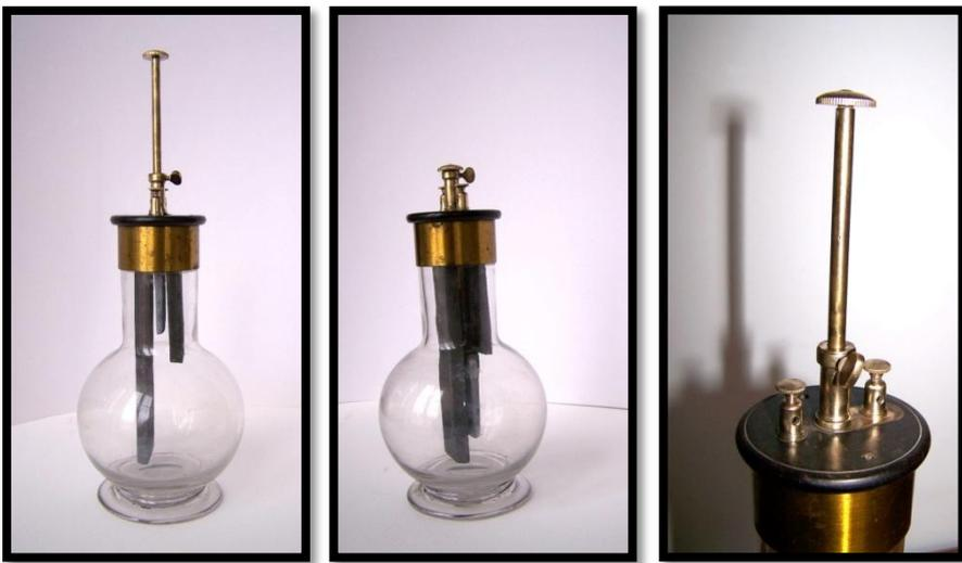
Ci-dessus, on peut voir l'électrode en zinc en position haute et basse, ainsi que le bouchon de la pile Grenet. Il est à noter que l'électrode charbon de droite est cassée à mi-hauteur. (Photos Coll. G. Vigneau) A droite, les deux éléments séparés.
